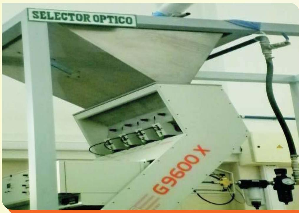
Figura 21. Selector óptico sirve para separar los granos de color
