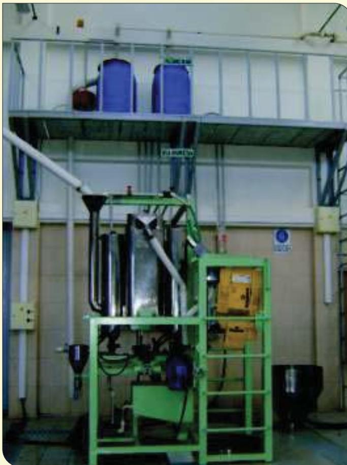
Figura 23. Máquina despedadora, lavadora, enjuagadora y centrifugadora
